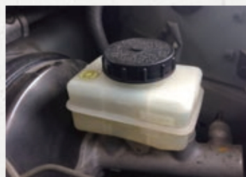
●エンジンルーム内のどこかにブレーキフルードのリザーバータンクが備わっている。これのフタを開ければ汚れ具合などが確認できる。
